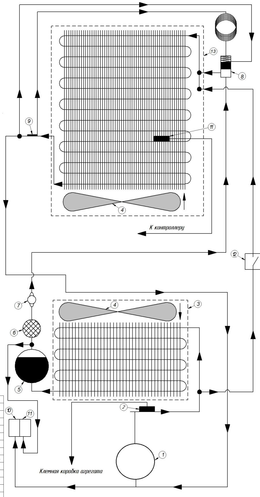
Рис.2 Принципиальная схема системы охлаждения
