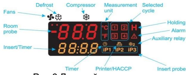
Рис.6 Дисплей контроллера
